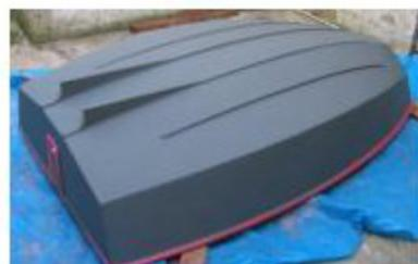
Для строительства лодки я использовал эпоксидную смолу, а затем, в значительной степени закончив оставшуюся работу по обработке древесины обычными красками. Внешность корпуса и интерьера резервуаров плавучести была окрашена, и интерьер лодки
