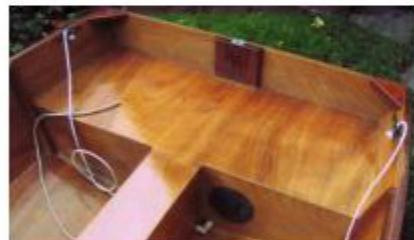
Для завершения, были установлены маленькие внутренние брештуки, чтобы усилить узлы соединения бортов и транца.
