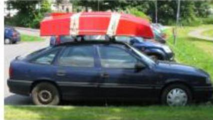
Лодка транспортируется на багажнике моей машины. Поперечины багажника не достаточно длинны, чтобы поддерживать лодку вверх ногами, так что я сделал некоторые деревянные бруски, которые прикрепляются к поперечинам и дополняются ободками, чтобы защитить привальный брус. Достаточно просто для двух человек, чтобы поднять одну сторону лодки и поместить её на конец поперечин и затем сдвинуть.
