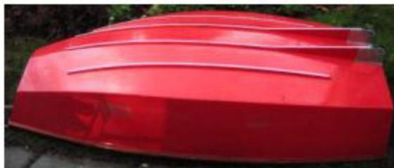
Алюминиевые накладки по килям предотвращают большую часть повреждений днища корпуса. Алюминиевые пластины, поддерживающие колеса – являются продолжением накладок, так что лодка будет гладко скользить от колес до накладок при преодолении препятствий.
