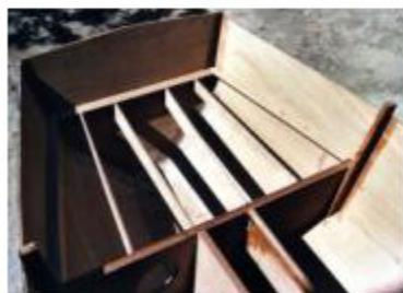
Внутри блоков плавучести, к корпусу были прикреплены поддерживающие шины, на которые приклеиваются края палубы. В кормовой части, где есть приблизительно прямое угловое соединение, я использовал прямоугольные строганные деревянные рейки. В носовой части, где бортовая планка изменяет угол, я вырезал полосы фанеры, примеряя по месту и затем прикрепляя их со смолой с наполнителем. Луки палубы - только фанера вырезанные фанерные планки, приклейенные на концах эпоксидной смолой с наполнителем.
