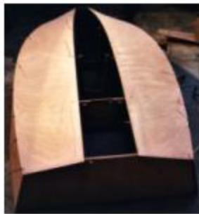
6. Продольный резервуар, собранный в разделе 1 и 2 был вставлен в отверстие в днище и вшит на место.
