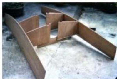
4. Стороны бортов были притянуты в задней части, фронте и постоянных переборках и транцах, и закреплены временными винтами. Малки были настроены на переборках и транцах так, чтобы борта соединились под правильными углами.
