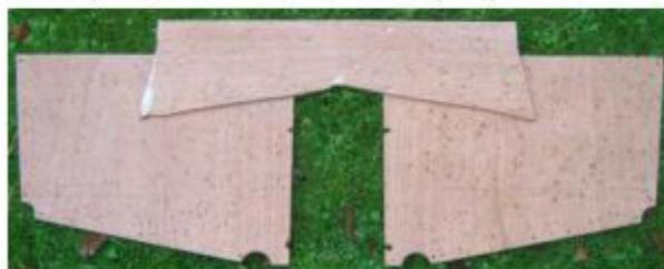
Две временных переборки также обязаны держать форму центра корпуса в течение сборки. Они были сделаны из отходов 9 мм фанеры. Уголки переборки были удалены так, чтобы обеспечить соединение их в завершении сборки и наведение гапталей. Отверстие в центре позволяет им быть установленными по продольному сиденью.
