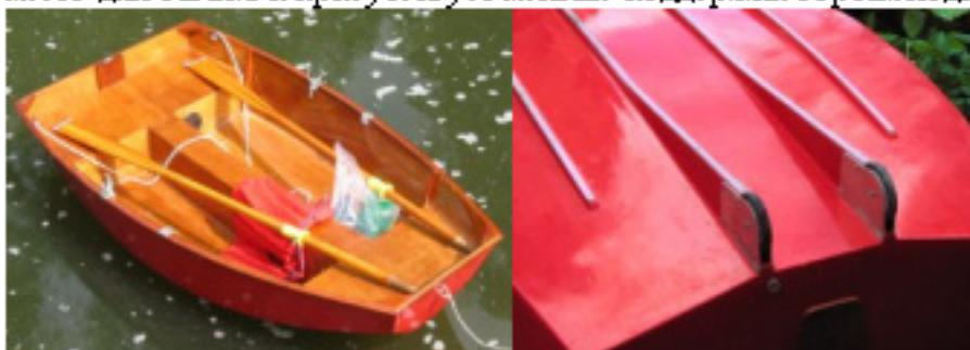
Другая немного необычная особенность – постоянные колеса, установленные в двойных книлях-реданах. Они очень удобны, поскольку эта лодка может доставляться к воде без специального трейлера или переноса. Это вместе с алюминиевыми полозьями на реданах, доходящими до транца, позволяют лодке проходить через конкретные сложные участки.
