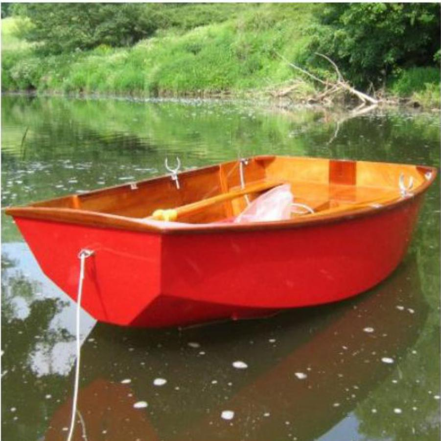
Маленькая плоскодонная шлюпка длиной 8 футов (2.4 метра), сделанная из фанеры 6 мм и эпоксидной смолы, используя метод Сшей и Склей (Stitch and Glue). Полностью бесплатный проект с размерами, а также с возможностью распечатки на многократных страницах, используя принтер формата А4.
