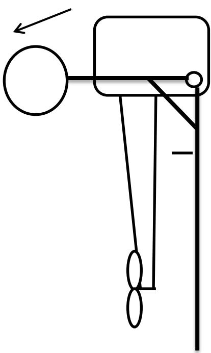
Наклонить для установки на лодку
