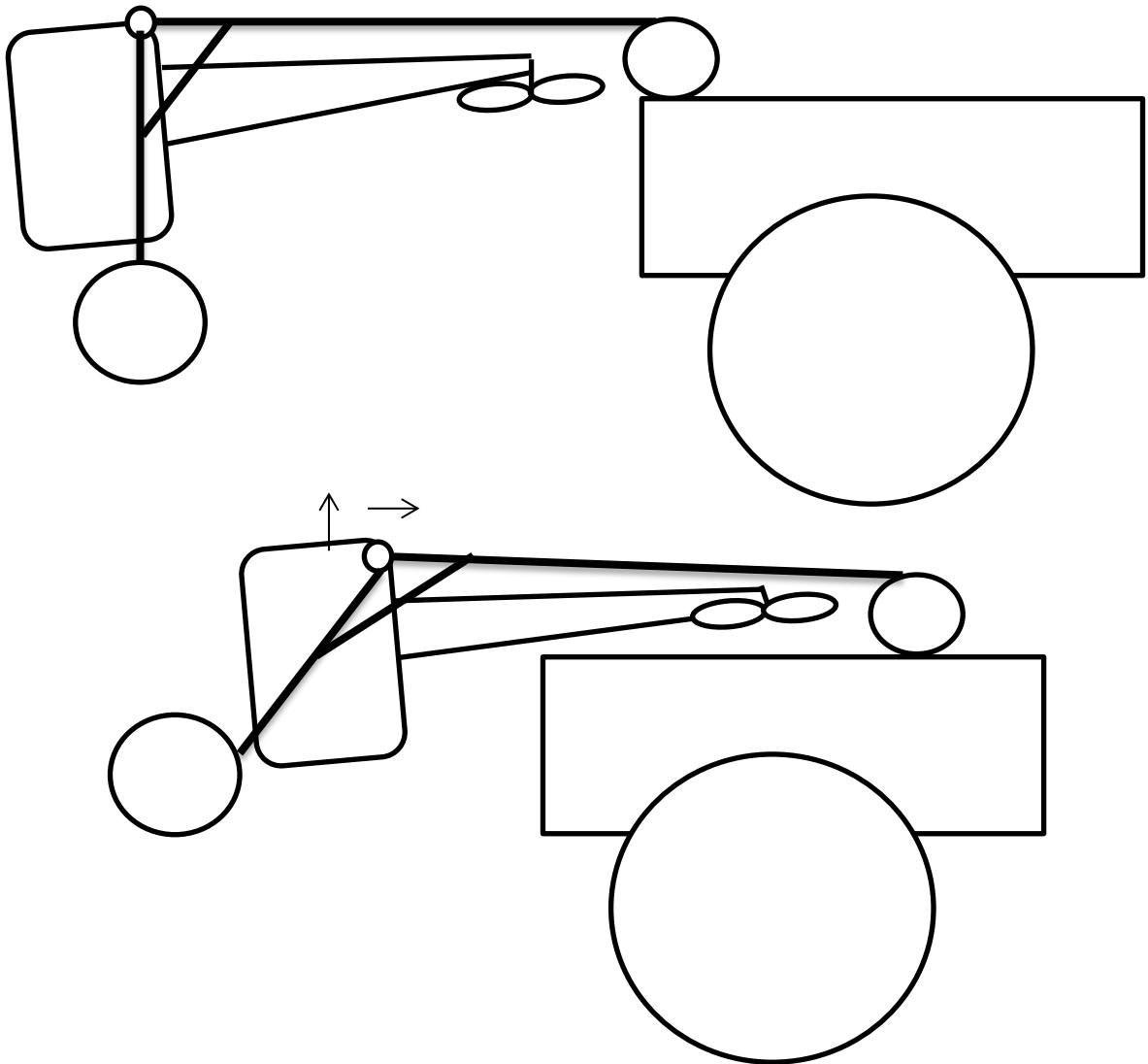
Меняя положение укосины поворачиваем раму с колесами ,уменьшаем высоту до нужного габарита . Продвигаем вверх и вперед .
